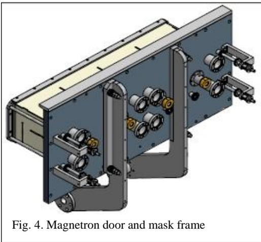
Fig. 4. Magnetron door and mask frame
